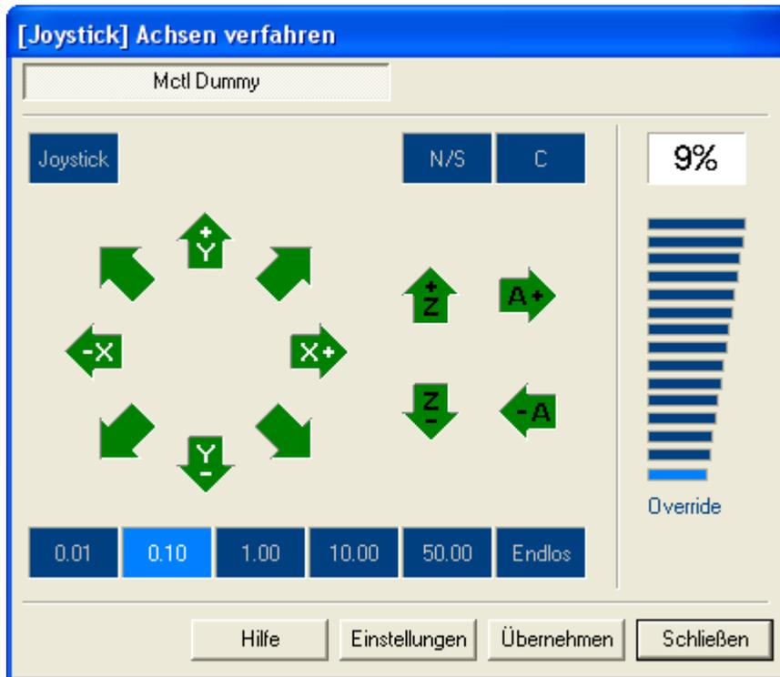
Nach dem Öffnen des Dialogs werden auf dem LCD der Betriebsmodus und die Koordinaten der ersten beiden Achsen angezeigt. Über den Button "Einstellungen" können Sie nun die Grundeinstellungen für Teach-Geschwindigkeiten und Schrittweiten verändern.
