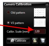
3. Unter 'Calibr. Scale' muss die korrekte Skalengänge eingegeben werden. Diese können Sie am Rand des Kalibriermusters ablesen.
