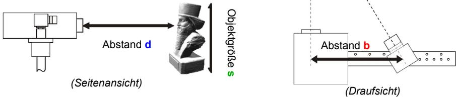
Bevor Sie die Geräte anschließen und einschalten, passen Sie den gesamten Scanaufbau an die Größe des zu scannenden Objekts/Objektausschnitts an. Der Schnittwinkel zwischen Projektionsrichtung und Kamerablickrichtung sollte ca. 20°-25° (max. 15°-35°) betragen.
