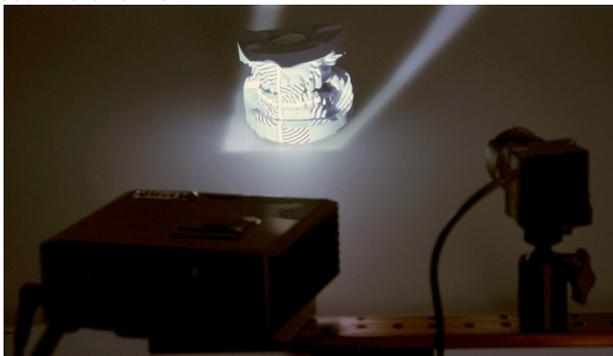
4. Stellen Sie die Schärfe des Projektors an dessen Fokusring so ein, dass die Streifen auf der Objektfläche scharf abgebildet werden.
