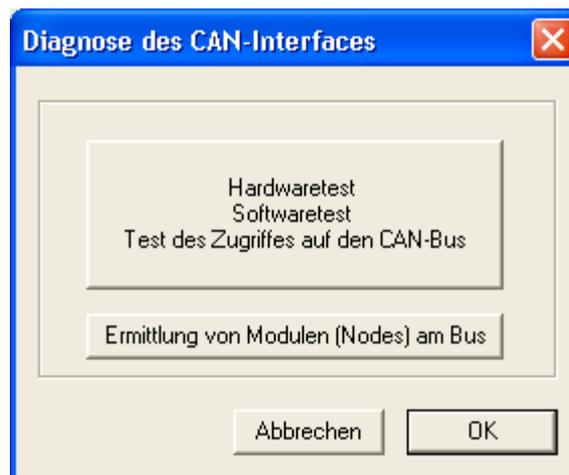
Mit der Schaltfläche „Ermitteln von Modulen (Nodes) am Bus“ können sie wie bereits beschrieben die Knotenadresse des iSM5 ermitteln.
