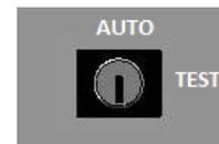
Im **Automatikbetrieb (AUTO)** kann die Haube bzw. **Tür nur geöffnet** werden, wenn die **Achsen keine Bewegung** ausführen und die angeschlossene **Frässpindel ausgeschaltet** ist. Wenn die Haube freigegeben ist leuchtet der COVER-Taster.
