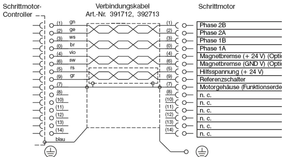
**Bild 4: Aufbau der Motoranschlussleitung**
