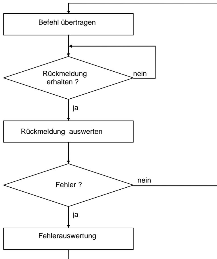
Zunächst wird ein Befehl an die Steuerung übertragen. Der Befehl wird von der Steuerung dekodiert und abgearbeitet, anschließend generiert die Steuerung ein entsprechendes Quittierungs- oder Fehlerzeichen.
