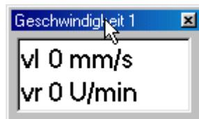
Anzeige der **aktuellen Verfahrensgeschwindigkeit** (momentane Bahngeschwindigkeit während einer linearen Interpolation, einer Kreisinterpolation oder einer Bahndatenbearbeitung)
