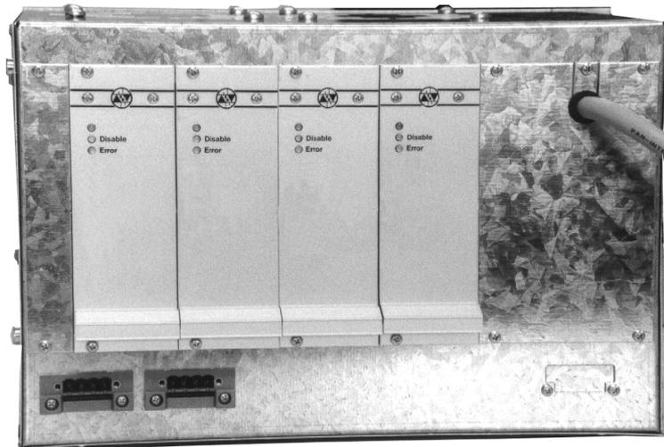
Servomotor-Leistungseinheit PVM 0810
