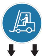
**Die Auflagepunkte für den Transport der Maschine mit einem Gabelstapler sind mit diesem Pictogramm gekennzeichnet.**
