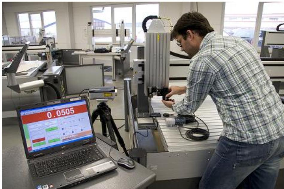
Abbildung: Laser-Vermessung einer isel-Basismaschine im Werk Dermbach in Thüringen
