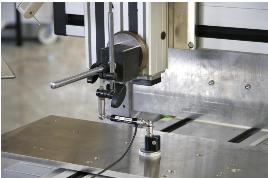
Abbildung: Kreisform-Vermessung mit dem Kreisformmeßsystem QC20 von Renishaw an einer isel-Basismaschine
