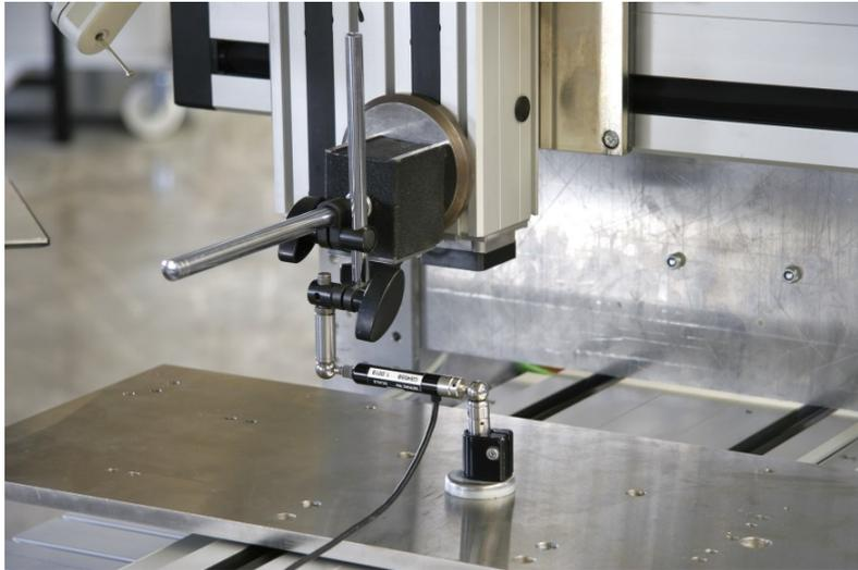
Abbildung: Kreisform-Vermessung mit dem Kreisformmesssystem QC10 von Renishaw
