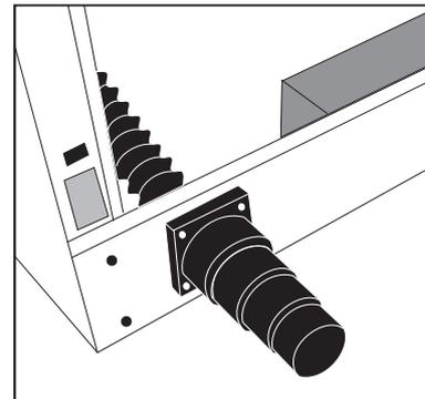
Entfernen Sie die Rückwand der CPM und die Abdeckung der runden Öffnung links unten. Schieben Sie den Saugschlauch durch die Öffnung und drehen Sie den Stutzen auf das Schlauchende. Den Stutzen schrauben Sie außen vor die Rückwand.
