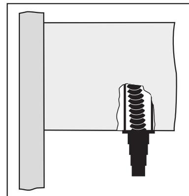
Auf der rechten Seite ist der Adapter mit einem Blech von unten auf das Profil fertig vormontiert.
