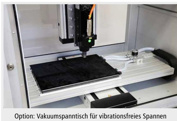
Option: Vakuumspanntisch für vibrationsfreies Spannen
