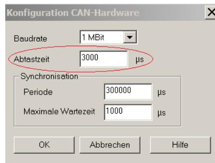
Alle anderen Parameter der mit CANSet erzeugten Initialisierungsdateien für beide Kanäle können verschieden sein. D. h. wenn Sie wollen, können Sie z. B. beide CAN-Kanäle mit unterschiedlichen Baudraten betreiben.
