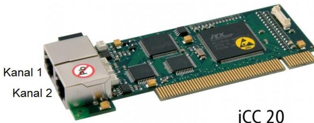
Die beiden CAN-Kanäle arbeiten unabhängig voneinander. D.h. mit den beiden Kanälen können Sie dann zwei unabhängige CAN-Stränge betreiben. Die Anwendungen dafür sind vielfältig:
