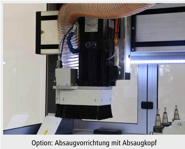
Option: Absaugvorrichtung mit Absaugkopf
