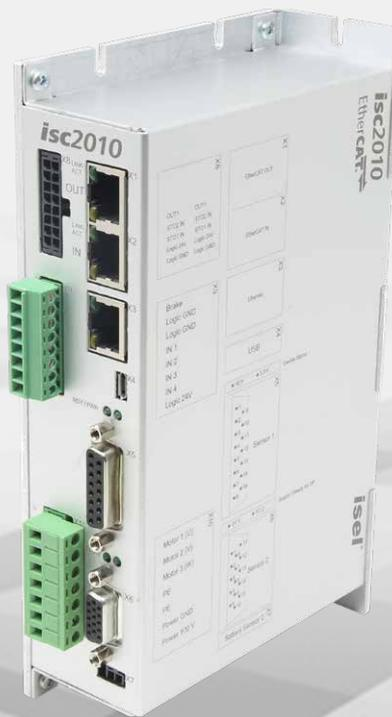
Der **isc2010** ist ein universeller Servo-Controller mit doppeltem Multi-Geber-Interface zum Steuern von Permanentmagnet-Synchronmotoren, Torquemotoren und Linearmotoren im Leistungsbereich von 1,2 kW bei einer Nennspannung bis 100 V. Kurze Regler-Zykluszeiten ermöglichen zusammen mit dem Echtzeitbussystem EtherCAT hoch-dynamische Positionieranwendungen.
