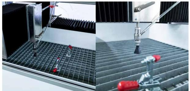
iWS 1000+ mit 22 kw Hochdruckpumpe mit platzsparender 4000 Bar Verrohrung und Fernsteuerung der Pumpensteuerung über Laptop.
