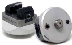
Zentrischspanner - 45–70 mm Backenbreite - 16 KN Spannkraft - optionale Backen verfügbar Art.-Nr.: 680800 0820
